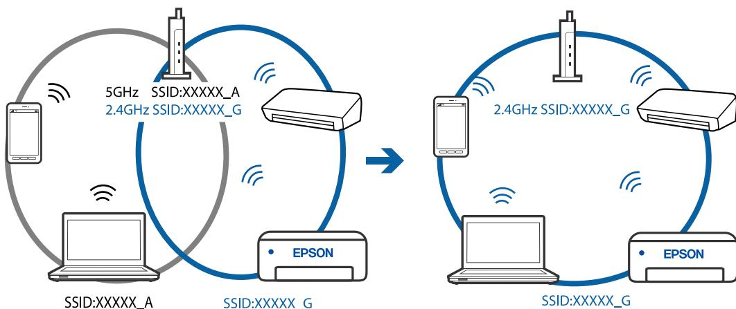
**На беспроводном маршрутизаторе доступна функция разделения устройств.**
