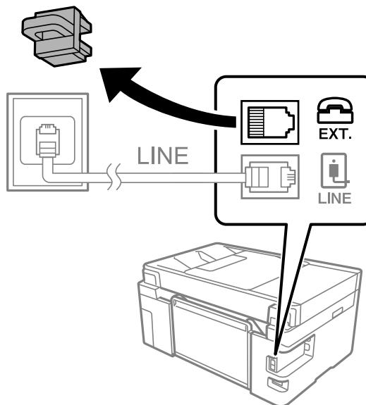
2. Соедините телефонный аппарат с портом EXT. с помощью телефонного кабеля.
