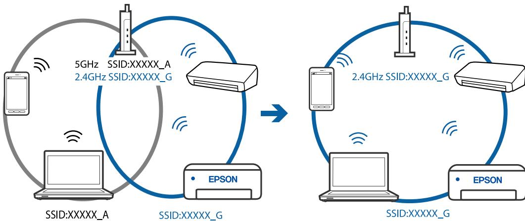
■ **На беспроводном маршрутизаторе доступна функция разделения устройств.**
