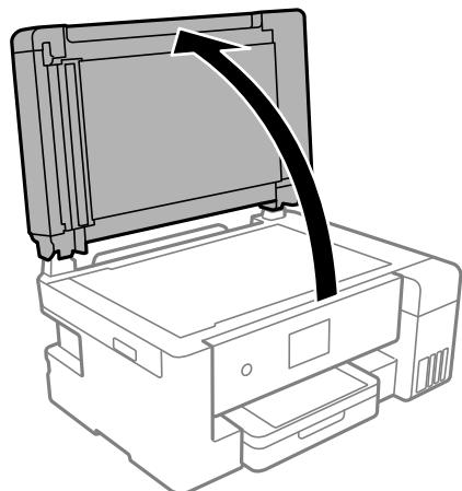
2. С помощью мягкой сухой чистой ткани удалите пыль и пятна со стекла сканера.
