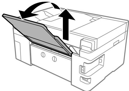
2. Снимите заднюю крышку.
