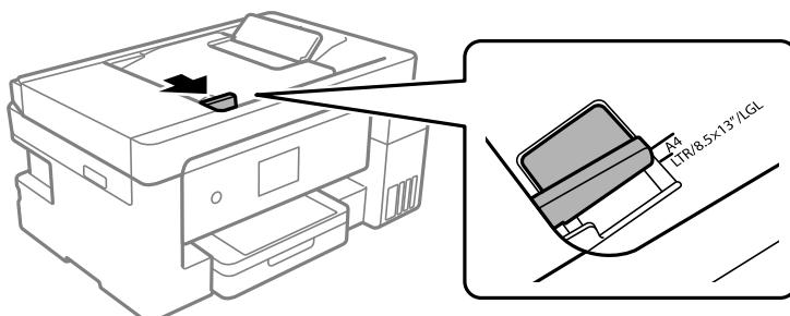
4. Разместите оригиналы на устройстве ADF печатной стороной вверх и коротким краем вперед, а затем сдвиньте боковую направляющую этого устройства к краю оригиналов.
