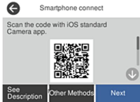
5. Запустите стандартное приложение «Камера» на устройстве iPhone, iPad или iPod touch и просканируйте с его помощью QR-кода, отображаемого на панели управления принтера, в режиме PHOTO (Фото).
