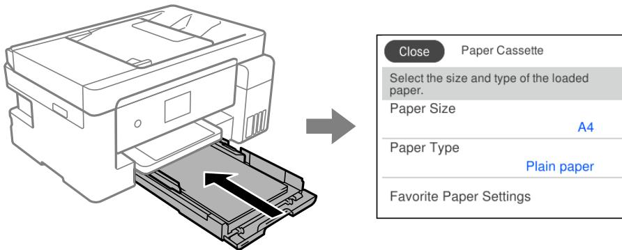
Если отображаемые размер и тип бумаги отличаются от соответствующих параметров загруженной бумаги, выберите элемент, который необходимо изменить. Если же отображаемые параметры соответствуют параметрам загруженной бумаги, просто закройте экран.
