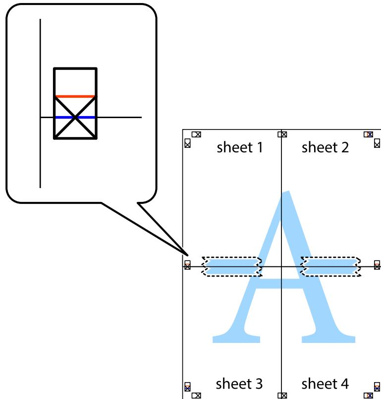
8. Разрежьте соединенные листы пополам вдоль красной горизонтальной линии, проходящей через метки для совмещения (в данном случае это линия над метками пересечения).
